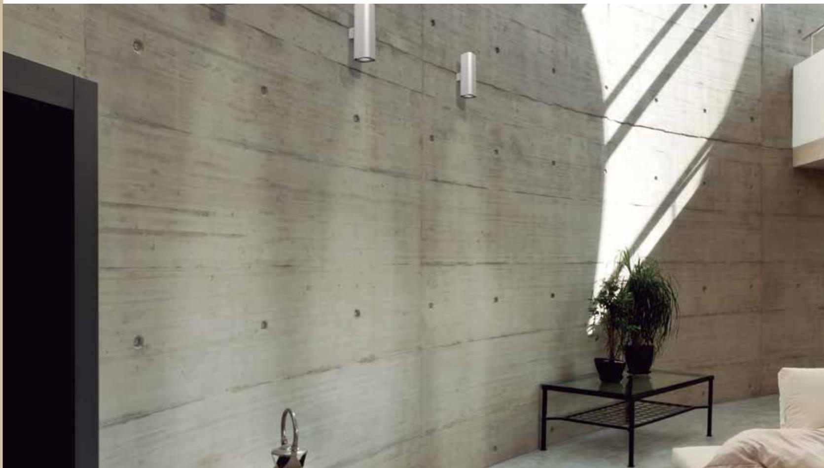
NEXIA a intégralement conçu la famille PLATINUM pour l'adapter à la dernière technologie LED avec un ballast européen de grande renommée. Fabriquée en aluminium de grande pureté, alliage 6063 et traitement T5, PLATINUM offre un large éventail de possibilités et compte à présent dans sa gamme une version plafonnier, suspendue et applique murale.
